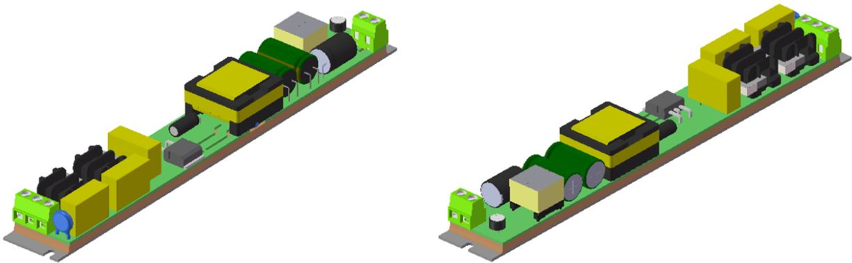
Рис. 2 Блок в исполнении на алюминиевой плите с клеммниками
