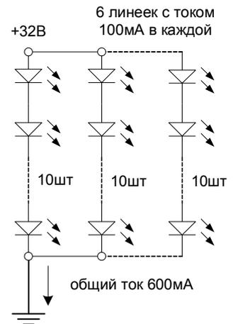
3. Выберем для последнего светильника другую схему подключения, тем самым покажем, что для этой задачи мы можем выбрать и другой блок питания с меньшим током, но с более высоким диапазоном выходных напряжений.
