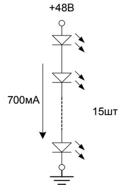
2. Считаем, что необходимо выбрать блок питания для светильника со световым потоком от светодиодов 1500Лм. Для засветки используются светодиоды STW8Q2PA производства фирмы Seoul Semiconductor. В документации на светодиод указано, что один светодиод дает световой поток порядка 25Лм при токе 100мА и напряжении 3.2В.
