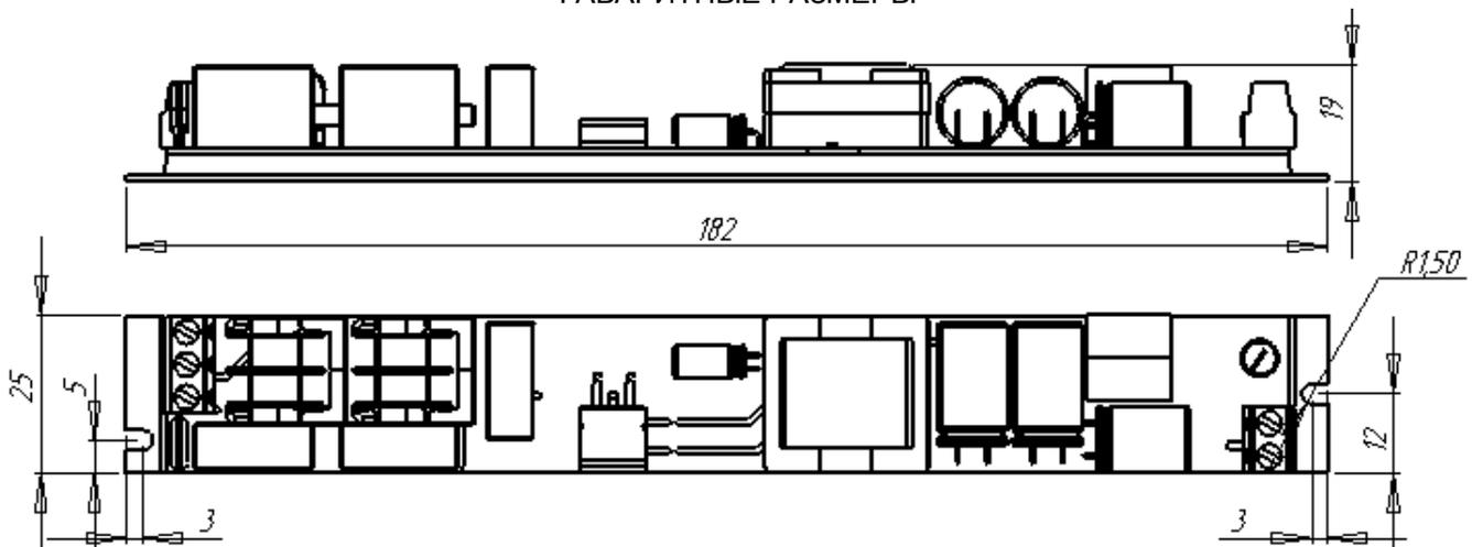
Рис. 3 Размеры блока в исполнении на алюминиевой плите с клеммниками
